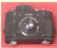
Radziecki aparat fotograficzny na mikrofilm, wzorowany na zachodniemieckim aparacie MINOX
