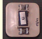
Kamuflaż nadajnika podchuchowego (mięszko elektryczne)
