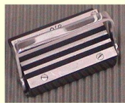
Urządzenie do przecinania filmu do wymiaru 9,5 mm (do aparatu AJAX)
