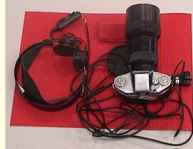
Urządzenie podchuchowe do dalszych odległości (zakamuflowane w postaci aparatu fotograficznego z lat 50-80 tych ze słuchawkami (EXA II, IMAGE Dorside)
