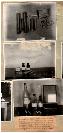
Fot. 18. Świece i rurki szklane napełnione świecą służące do pisma utajnionego na płótnie, atrament sympatyczny oraz wywoływacz w pastylkach. AIPN Wr 00200/3.
