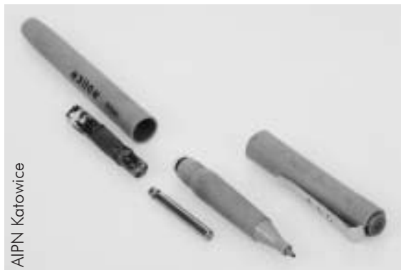
Podsłuch zamontowany w długopisie
